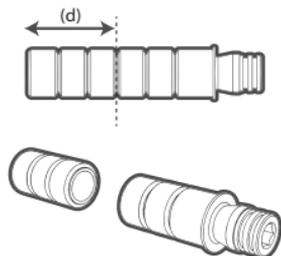
Couper le cylindre fileté à l'arrière (au niveau d'une des encoches), de façon à retirer la longueur mesurée (d).
