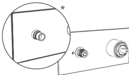
Remettre en place le cylindre fileté. La lèvres doit se retrouver contre la plaque de finition.
