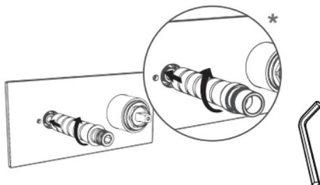
Mettre en place le cylindre fileté et mesurer la distance (d) entre la plaque de finition et la lèvres.
